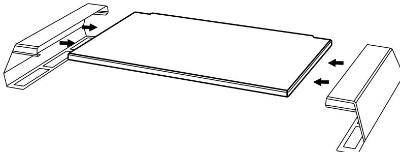
5. Platzier den Aufsatz so auf den Grillrosten, dass die **äußeren Brenner direkt unter der Lücke** zwischen Seitenteilen und dem schmalen Pizzastein, den du unten in die Mitte legst, positioniert sind. Der **mittlere Brenner** befindet sich dann **mittig** unter dem Pizzastein.
