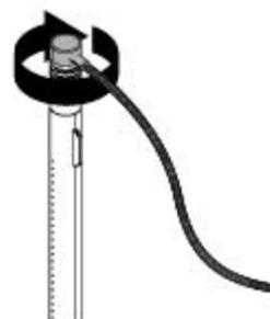
11. Führe ein Brennerrohr durch die dafür vorgesehene Öffnung in der Frontblende ein, sodass der Gasschlauch außen liegt und zu dir zeigt. Setze das Brennerrohr rechtwinklig ein und achte darauf, dass die Finne nach oben zeigt.
